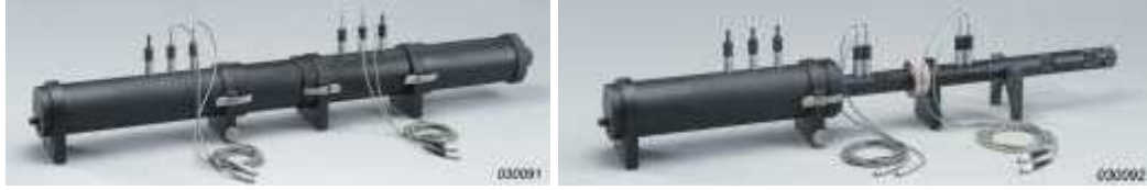
Şekil 1. Ses iletim kaybının frekansa bağlı olarak belirlenmesi amacıyla kullanılan ölçüm sistemi.
